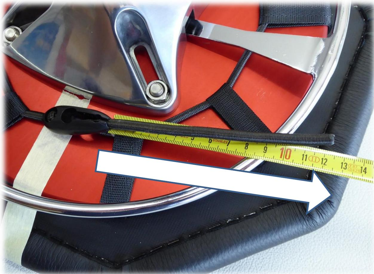
Elastikzug an Verschlussklipp anknuten. Der Verschluss macht so keine Klappgeräusche!
