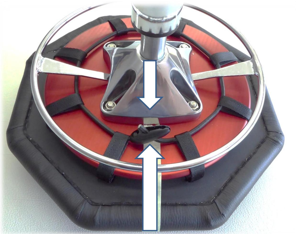
Den Elastikzug anziehen und in Kerbe einrasten lassen. Das Ende des Elastikzuges muss mindestens **12 bis 13 cm** herausragen!
