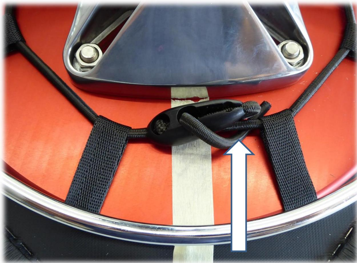
Elastikzug ringsum auf gleiche Spannung verteilen!
